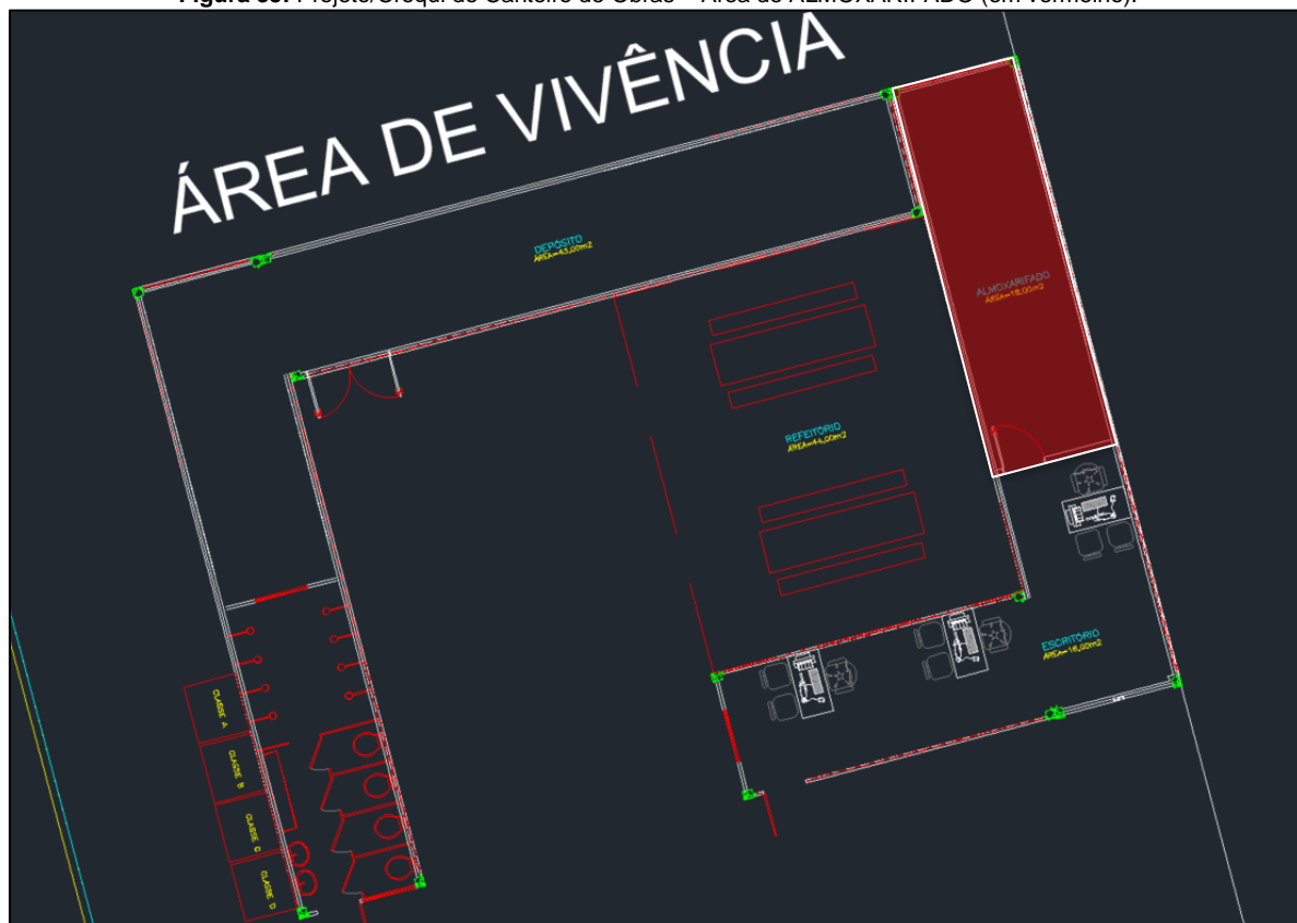
Figura 35: Projeto/Croqui do Canteiro de Obras – Área de ALMOXARIFADO (em vermelho).
