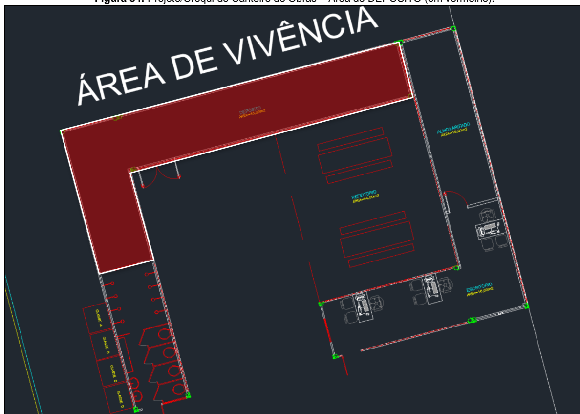
Figura 34: Projeto/Croqui do Canteiro de Obras – Área de DEPÓSITO (em vermelho).
