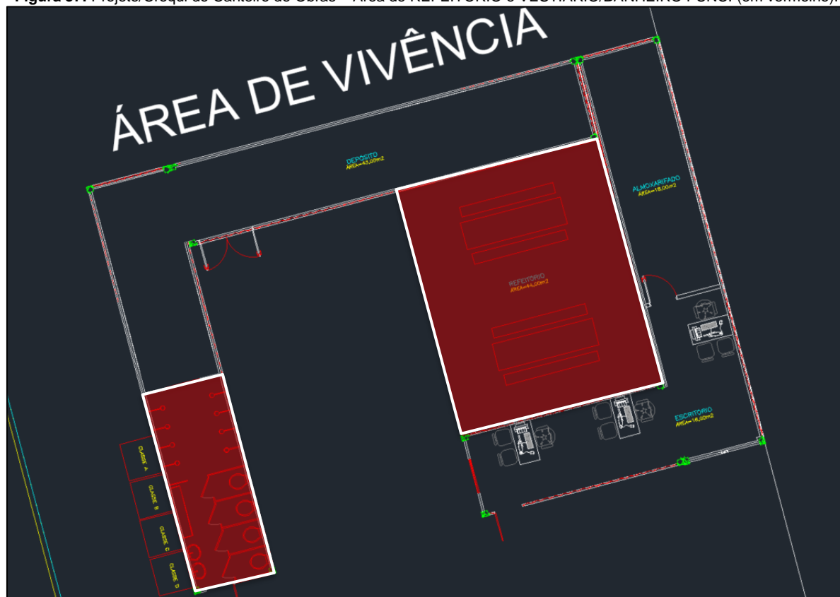
Figura 37: Projeto/Croqui do Canteiro de Obras – Área de REFEITÓRIO e VESTIÁRIO/BANHEIRO FUNC. (em vermelho).
