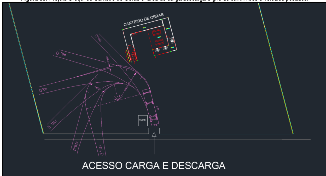
Figura 33: Projeto/Croqui do Canteiro de Obras c/ área de carga/descarga e giro de caminhões e veículos pesados.
